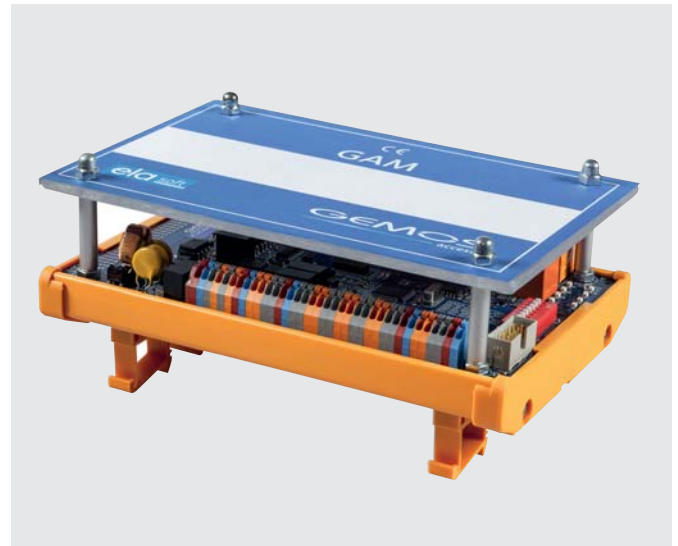
Hutschienenhalterung mit montiertem GEMOS access modul
